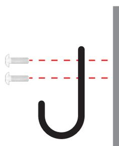
Fixe o suporte do cabo na parede com os 2 parafusos.
