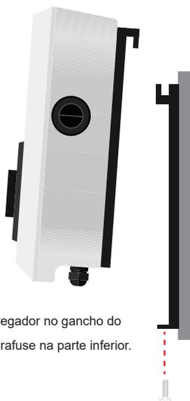
Fixe o carregador no gancho do suporte e parafuse na parte inferior.
