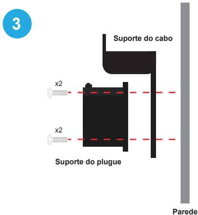
Fixe o suporte do cabo e do plugue com os 4 parafusos.
