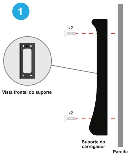
Fixe o suporte do carregador na parede com os 4 parafusos.
