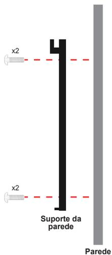
Fixe o suporte da parede na parede com os 4 parafusos.
